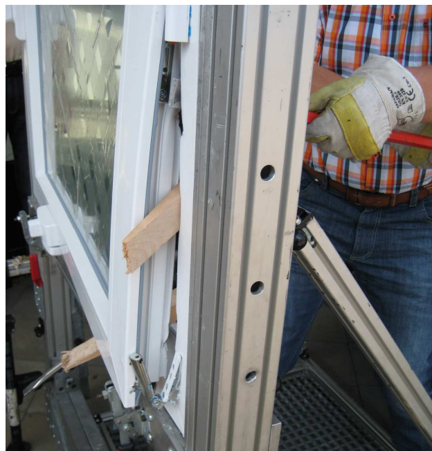
„Selbstversuch“ an einem nachgerüsteten Kunststofffenster mit großem Schraubendreher, Keilen und Kuhfuß zum Abschluss einer polizeilich anerkannten Grundschulung für Errichterbetriebe; die Verglasung wurde dabei allerdings nicht angegriffen (Quelle: iBAT GmbH; www.ibat-hannover.de )
