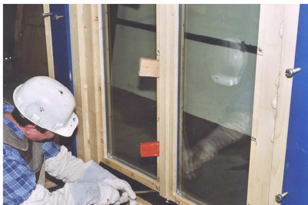
Laborprüfung der Einbruchhemmung einer 2-flügeligen Stulptür aus Holz durch das Prüfzentrum für Bauelemente PFB Rosenheim; www.pfb-rosenheim.de (Quelle: Tischler Schreiner Deutschland)
